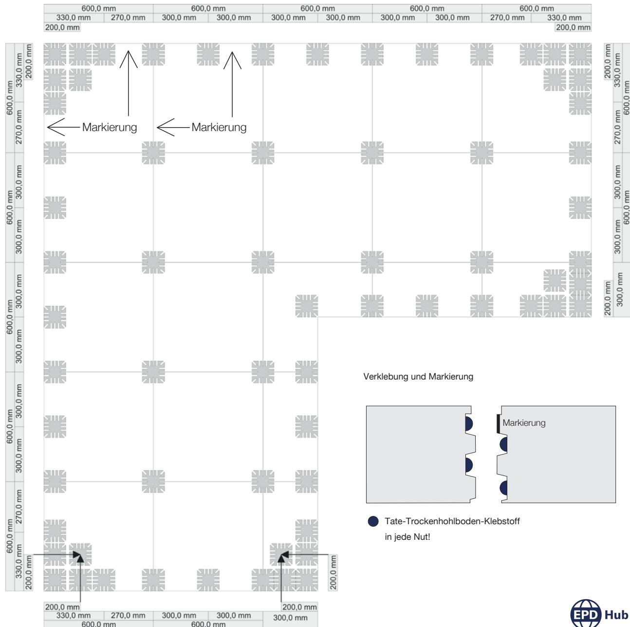
**Stützenanordnung:** Es ist darauf zu achten, dass die Eckstützen gerechnet von Mitte Stützenkopf 200 mm Abstand zu beiden Randanschlüssen aufweisen und zusätzlich zwischen Eckstütze (Wand) und 300 mm Randrasterstürze nochmals eine zusätzliche Stütze in beide Richtungen positioniert wird. Diese Positionierung ist zwingend einzuhalten.
